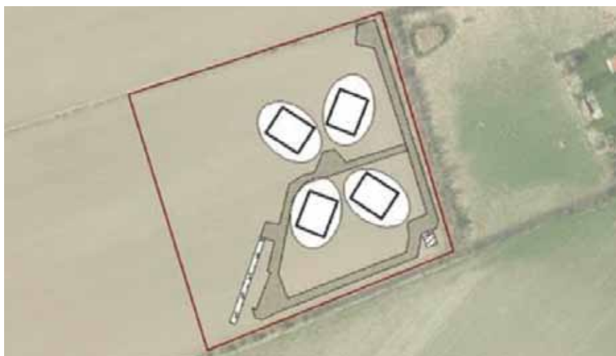
Firkløveranlægget med fire bassiner som blade og et efterpoleringsbassin som stilken
